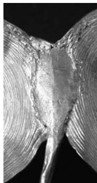
Figura 11. Detalle del extremo proximal de la aguja soldado a la intersección de los conos, en el “reverso”.
