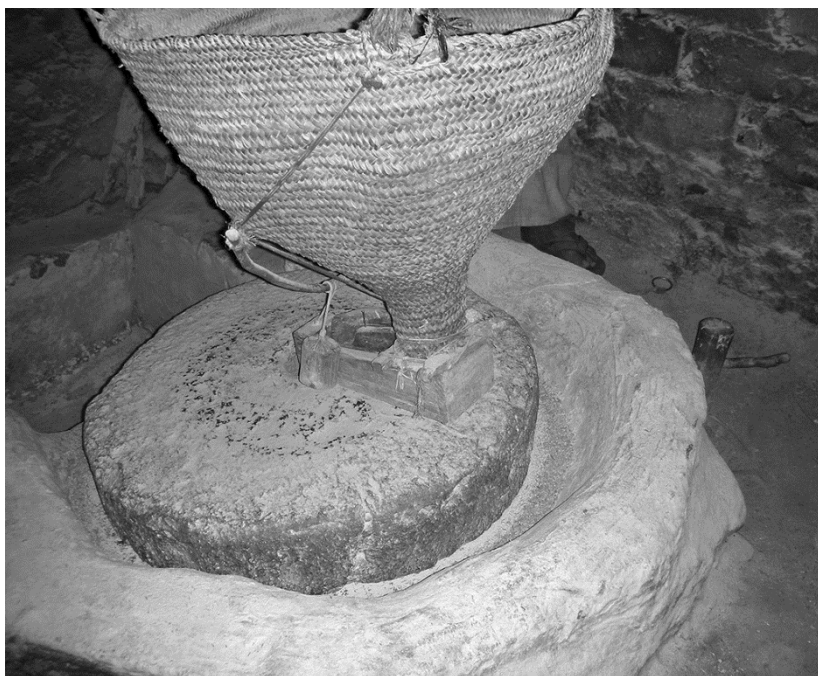
Figura 14. Estructura circular de barro para instalar las piedras molederas aún en uso en ciertas regiones rurales del Magreb (foto, E. Sandoval).
