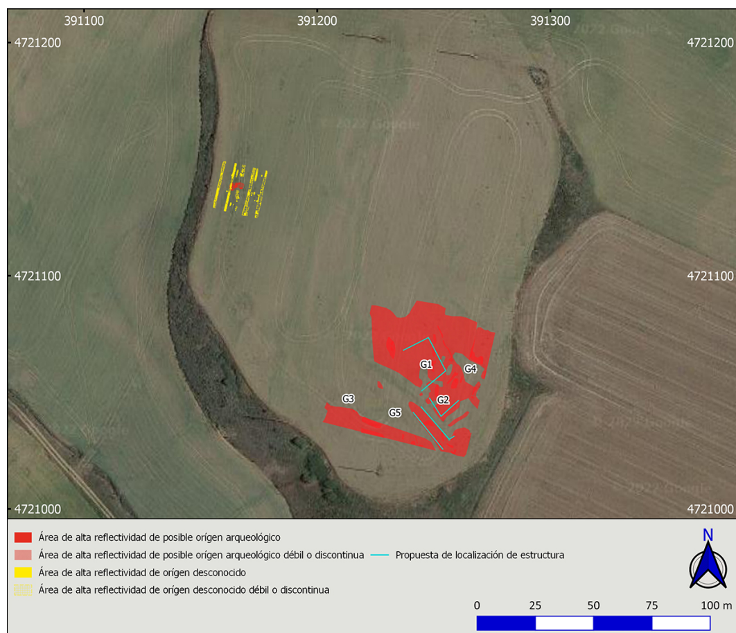
Figura 9. Doce Cantos. Interpretación sintética de la prospección por georradar sobre imagen satélite (Google Satellite).
