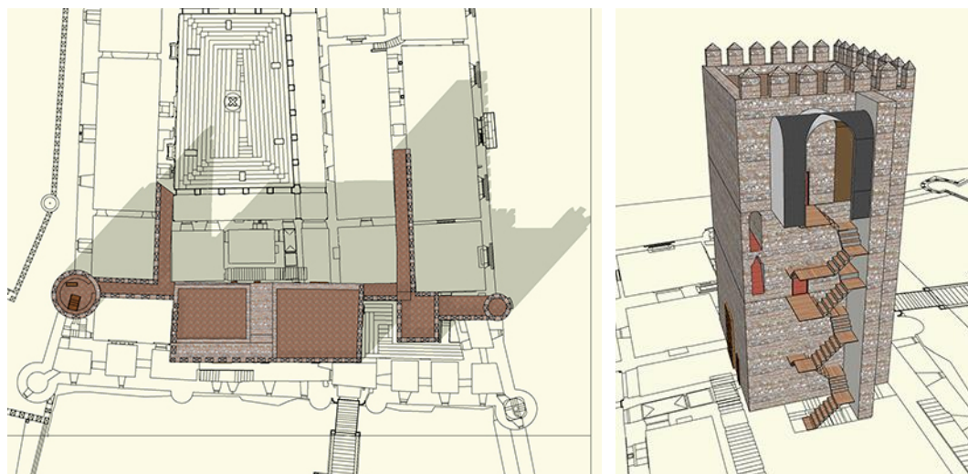
Figura 26. Unión de las torres central y sur.
